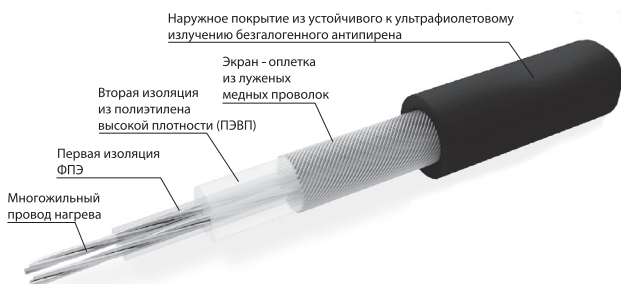
Конструкция кабеля нагревательного мата ELEKTRA SnowTec® Tuff
